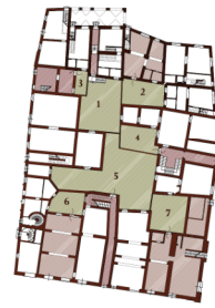
corti interne: pavimentazione - incollato di mattoni ordinari 1 - 3 - 4 - 5 pertinenza residenze 2 - 6 - 7 pertinenza botteghe PIANTA DELLE CORTI scala 1:500
